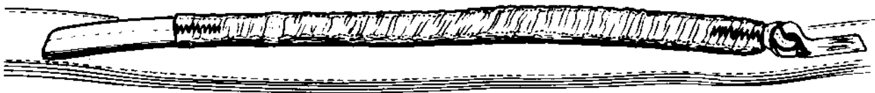
Fig. 4.18 - Fixation de la sanglette de tension
