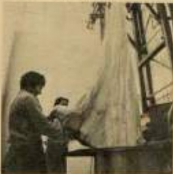
Le lavage des parachutes. Un crochet suspendu sur un rail fixé au plafond permet ensuite de drainer, sans effort, le parachute vers la salle de séchage.
